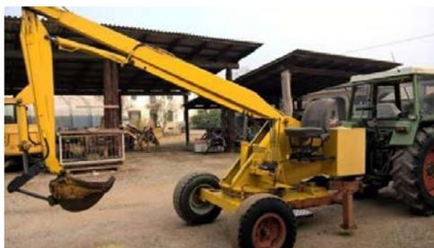
Tali attrezzature non sono solidamente fissate al trattore. Normalmente sono connesse al gancio traino oppure applicate al sollevatore a tre punti posteriori. Tale connessione non può essere considerata un "montaggio" di attrezzi, ma una connessione di una attrezzatura **che si discosta dall'abilitazione all'utilizzo del trattore.**
